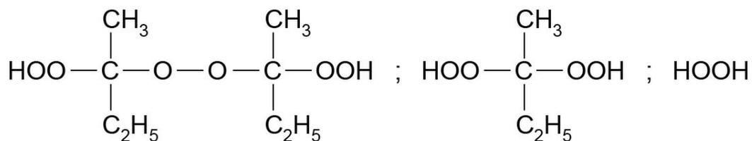
Butanox M-60 é o carro-chefe em sistemas de cura GRP, com oxigênio ativo 10% mais alto do que o Butanox M-50. Peróxido de metil-etil cetona (MEKP) de reação média com baixo teor de água garantido para cura de resinas de poliéster insaturadas na presença de um acelerador de cobalto a temperaturas ambiente e altas.
